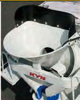
ホッパーの大型化、シールパイプ大径化で積込み性能向上。
