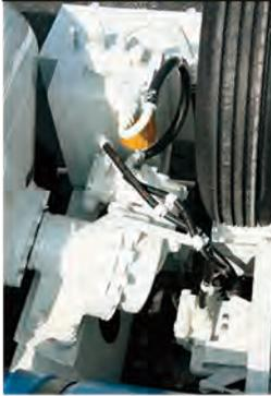
駆動メカニズムに4トン車と同じ油圧システムを採用。中立調整のわずらわしさから解放されます。ダイレクトな操作感を実現。
